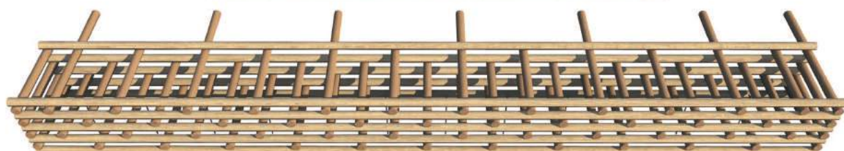
Vista assonometrica dello schema di composizione della palificata doppia
