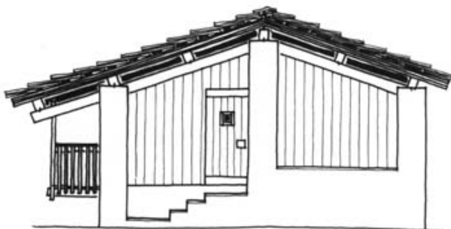
la chiusura dello sfondato è realizzata con un tamponamento ligneo posizionato in accentuato arretramento rispetto al piano di facciata al fine del mantenimento dell'effetto plastico delle parti in muratura
